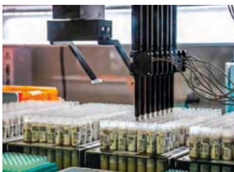
Diagnostické veterinárne laboratórium vo Wisconsine využíva robota na spracovanie vzoriek mlieka. Robot s láskyplným menom „Becky“ odoberá mlieko z predložených skúmaviek a presúva ho na platňu používanú na diagnostiku. Becky dokáže spracovať až 1 000 vzoriek denne.
